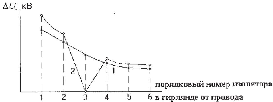
Рис.5. Распределение напряжения по гирлянде изоляторов без дефектного (1) и с дефектным (2) изолятором
