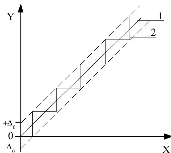
Рис. 8. Определение погрешности квантования
