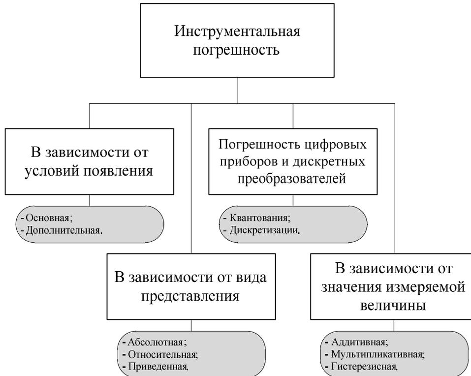
Рис. 4. Классификация составляющих инструментальной погрешности
