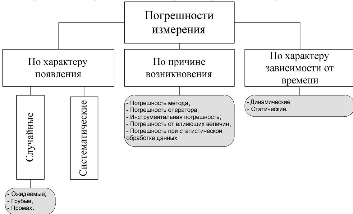
Рис. 3. Классификация погрешностей измерения
