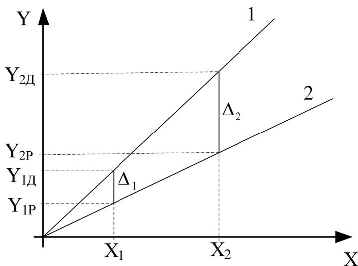
Рис. 5. Определение мультипликативной погрешности
