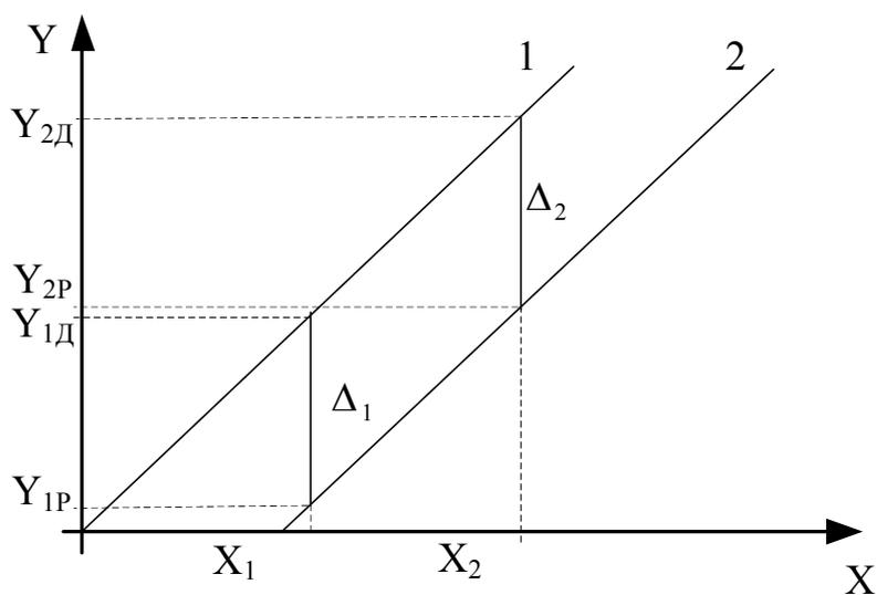
Рис. 6. Определение аддитивной погрешности
