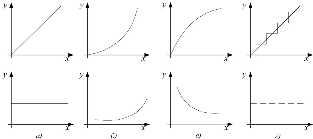
Рис. 1.16. Статические характеристики измерительных преобразователей:
