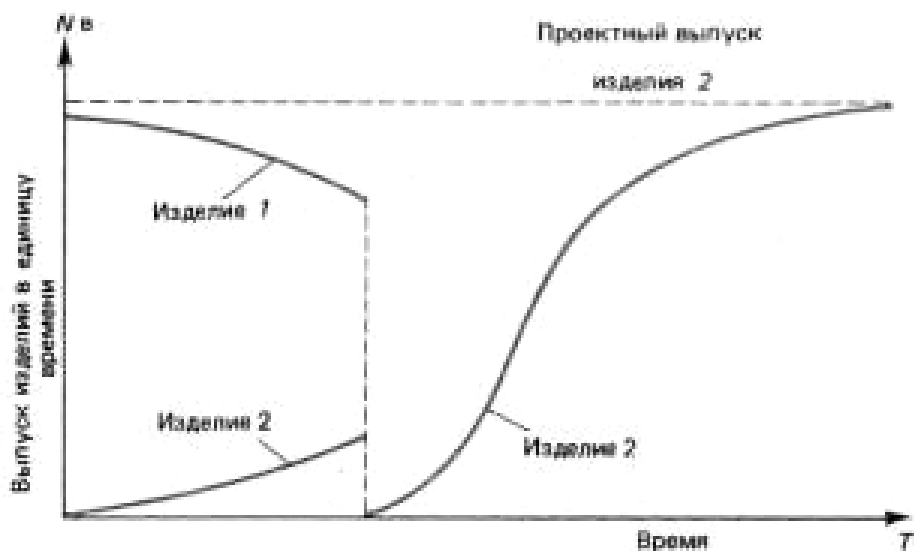
Рис. 2.16. Параллельно-последовательный метод перехода на выпуск нового изделия
