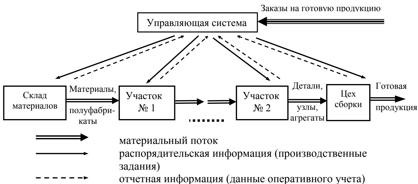
Рис. 1. Принципиальная схема толкающей системы управления материальным потоком в рамках внутрипроизводственной логистической системы.
