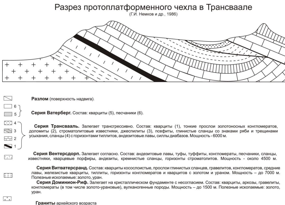
Рис. 34. Разрез протоплатформенного чехла Южно-Африканской платформы в Трансваале
