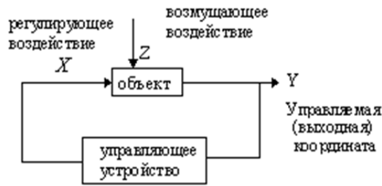
Рис. 1.3. Структурная схема замкнутой системы
