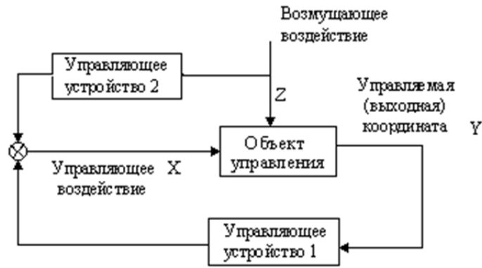
Рис. 1.5. Структурная схема системы управления с обратной связью и компенсацией возмущений
