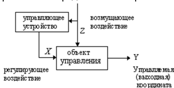
Рис. 1.4. Структурная схема разомкнутой системы
