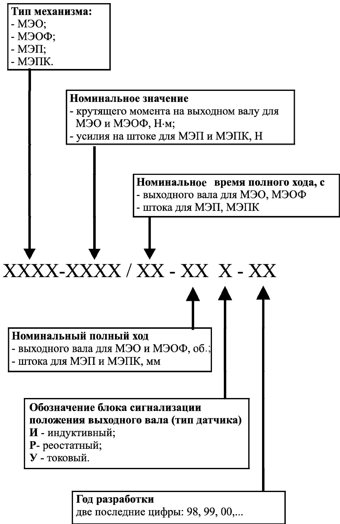
Рис. ПЗ.7. Структура условного обозначения исполнительных механизмов
