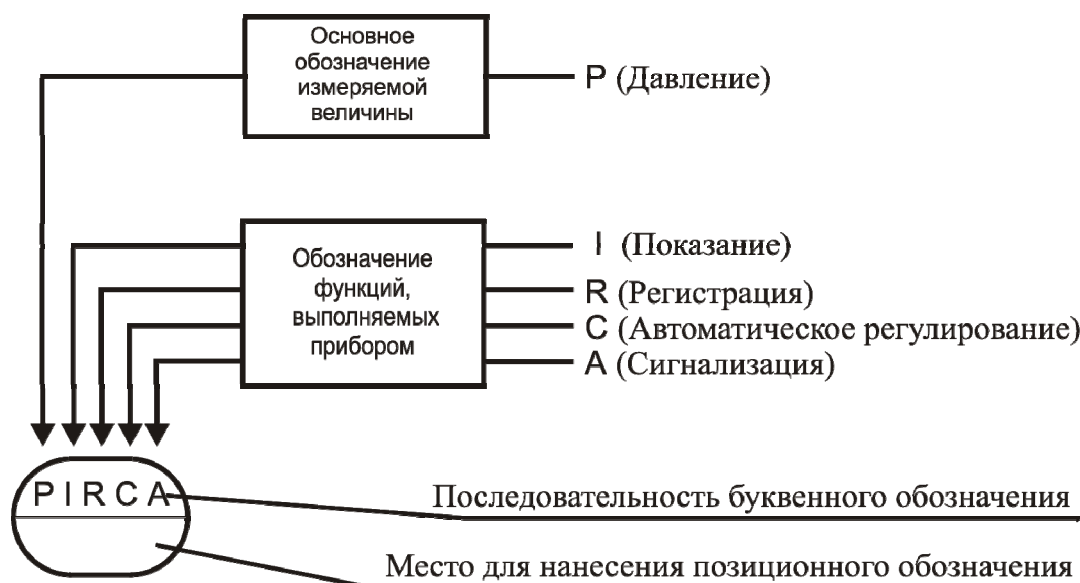
Рис. П1.1. Последовательность буквенных обозначений средств измерения и регулирования
