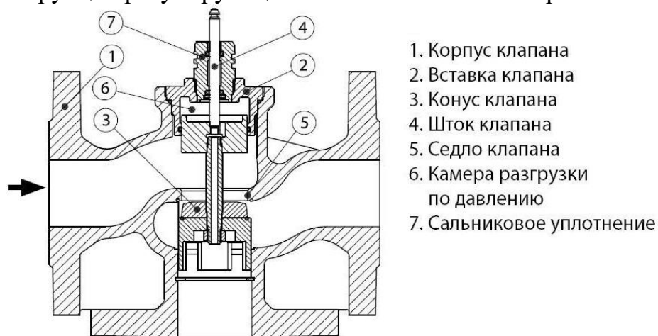
Рисунок 28 – Конструкция регулирующего клапана
