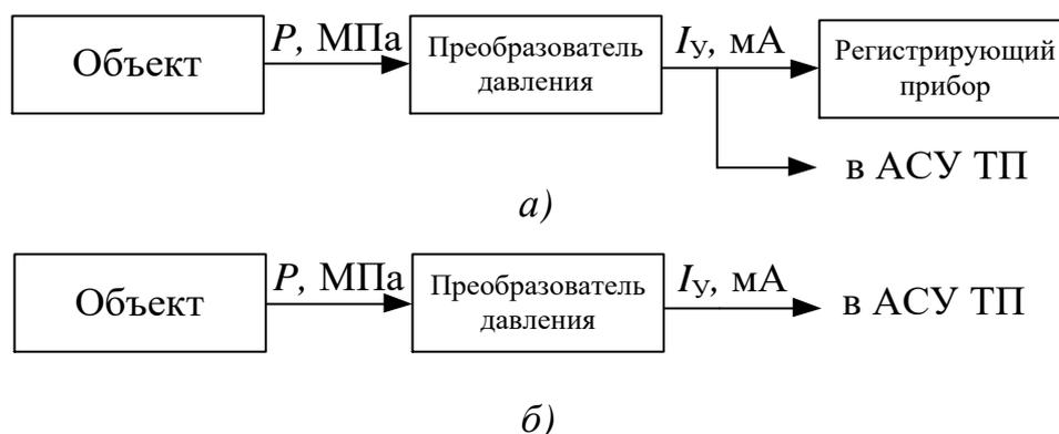
Рис. 58. Структурные схемы измерительного канала давления:
