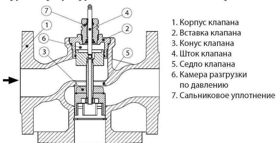
Рис. 9. Конструкция регулирующего клапана
