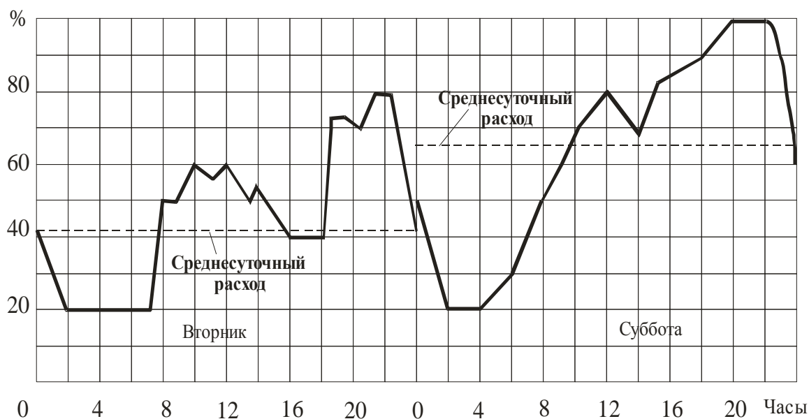
Рис. 2.2. Суточный график горячего водоснабжения жилого района
