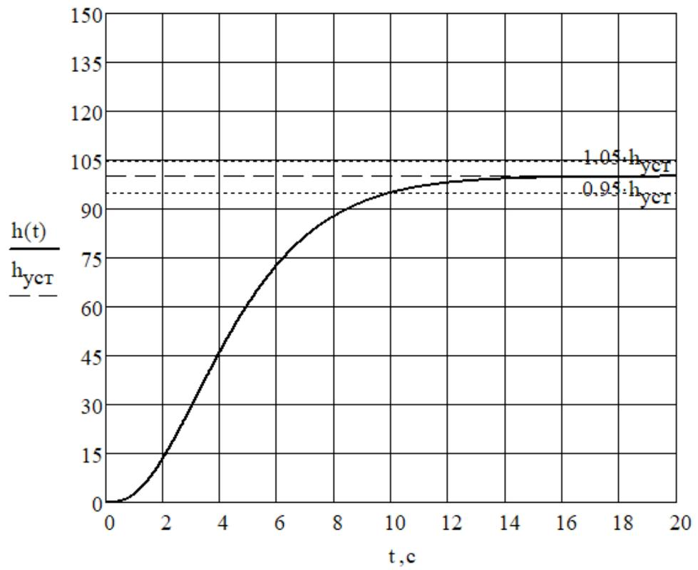
Рисунок 2.8 – Переходная характеристика системы с модальным регулятором, синтезированным по биномиальному распределению
