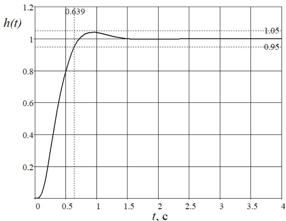
Рисунок 1.6 – Переходная характеристика системы со скорректированным ПИД-регулятором
