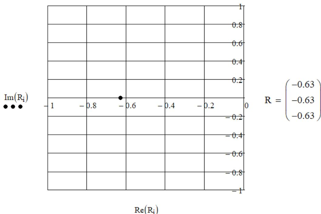
Рисунок 2.7 – Расположение полюсов системы с модальным регулятором, синтезированным по биномиальному распределению
