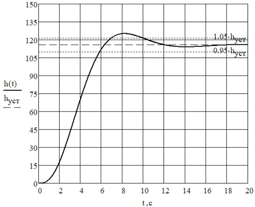
Рисунок 2.6 – Переходная характеристика системы с модальным регулятором, синтезированным по распределению Баттерворта
