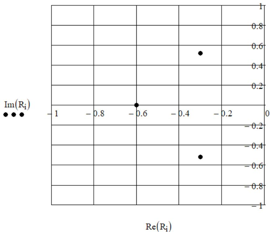
Рисунок 2.5 – Расположение полюсов системы с модальным регулятором, синтезированным по распределению Баттерворта
