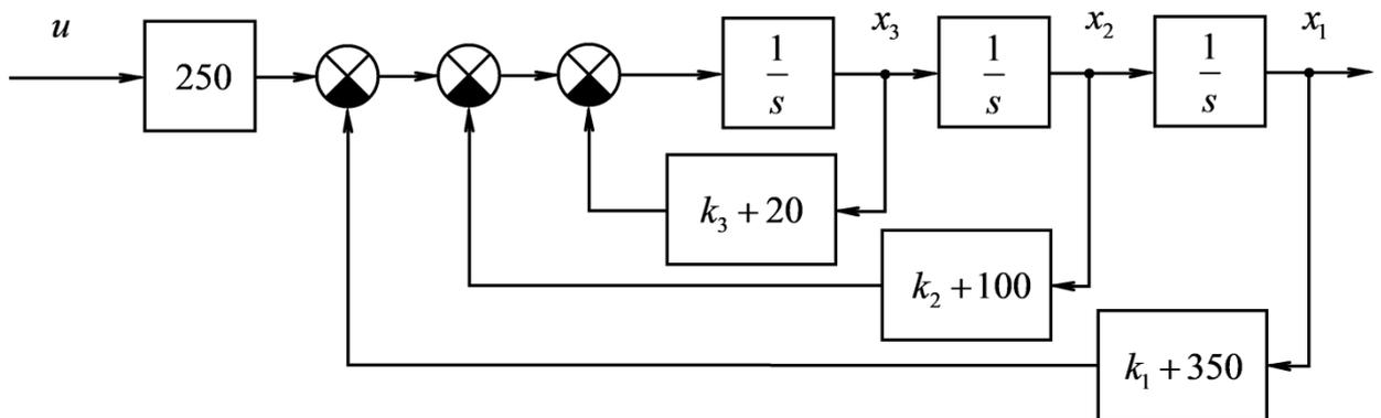
Рисунок 2.2 – Структурная схема системы с регулятором
