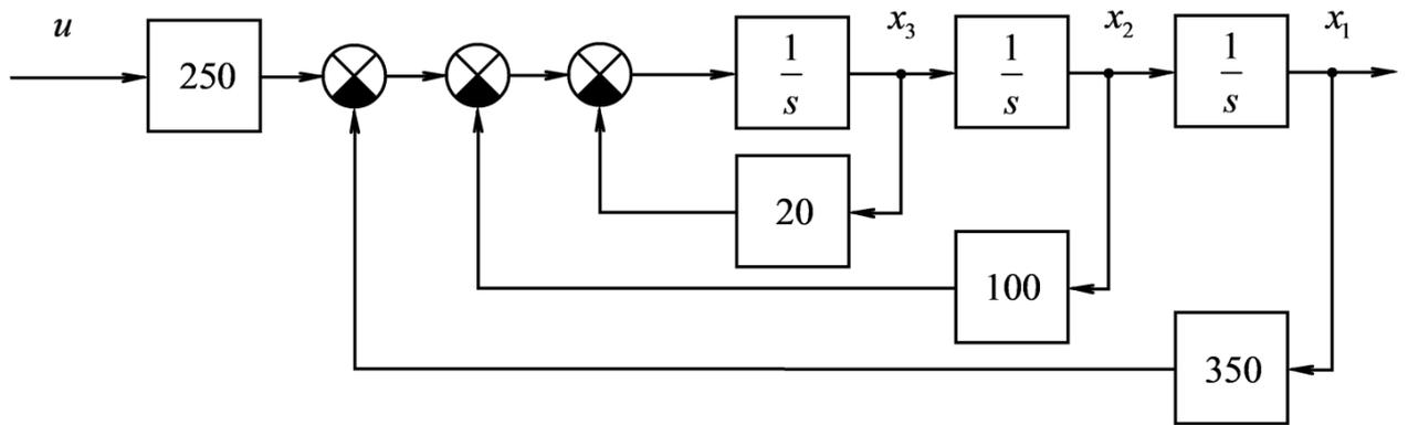
Рисунок 2.1 – Структурная схема обобщенного объекта управления исследуемой системы
