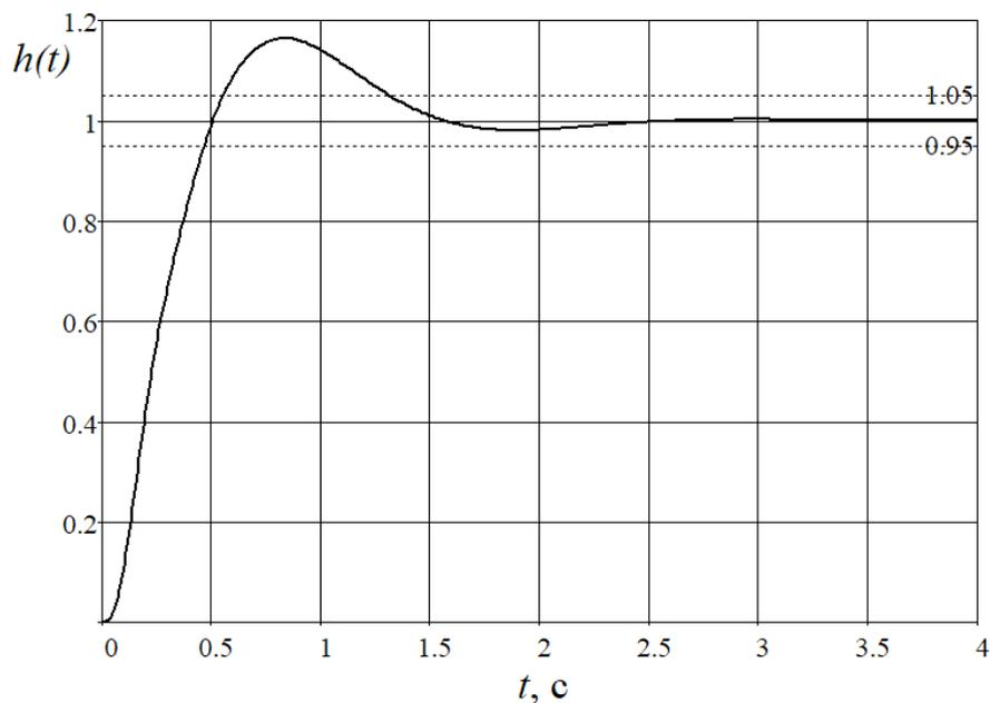
Рисунок 1.5 – Переходная характеристика системы с синтезированным ПИД-регулятором
