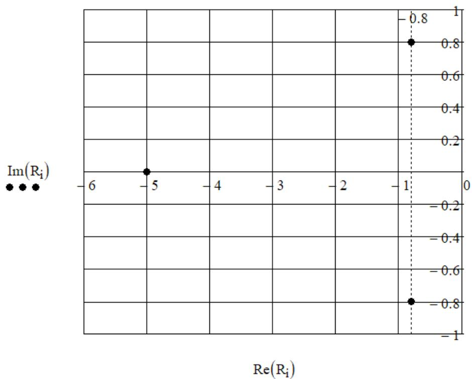
Рисунок 2.3 – Расположение полюсов системы с регулятором, синтезированным по желаемому характеристическому полиному
