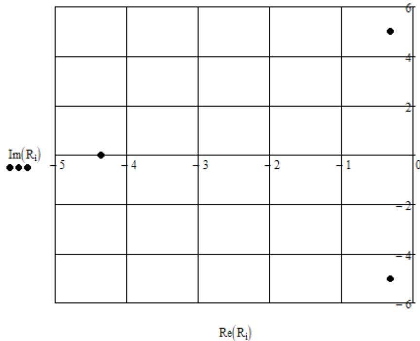
Рисунок 2 – Расчет корней характеристического уравнения исследуемой системы и отображение их на комплексную плоскость с помощью Mathcad
