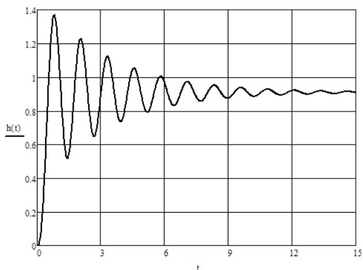
Рисунок 1 – Построение переходной характеристики исследуемой системы с помощью Mathcad
