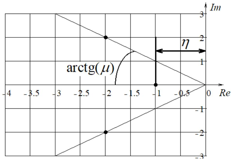
Рисунок 7 – Пример расположение полюсов системы автоматического управления для расчета корневых показателей качества
