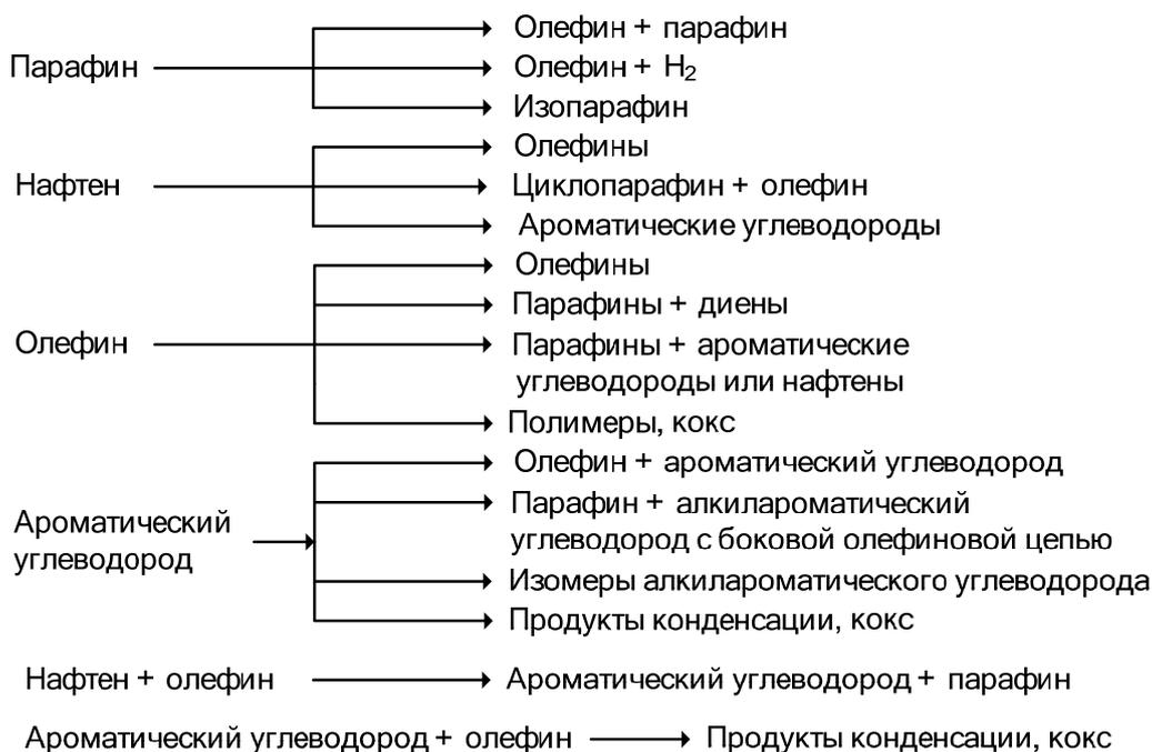
Рис. 43. Формализованная схема процесса каталитического крекинга
