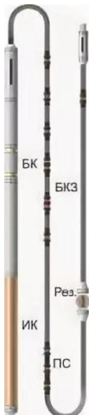
Рисунок 6 – Схема расположения точек записи зондовых установок прибора
