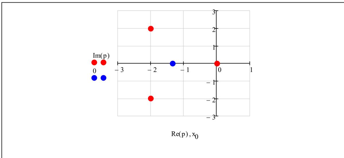
Находим углы наклона асимптот  $\phi_k = (2k + 1)\pi / (n - m)$ ,  $k = 0, 1, 2 \dots n - m - 1$
