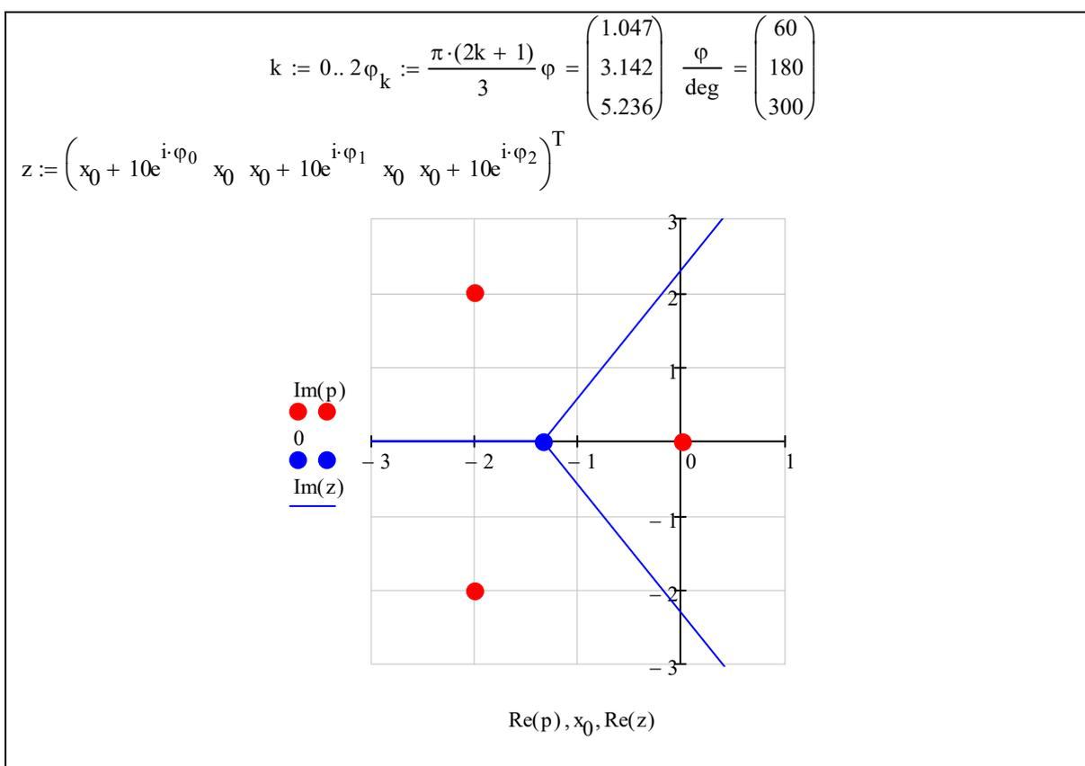
С помощью формулы учитывающей соотношение между углами полюсов на годографе находим углы наклона касательных к годографу
