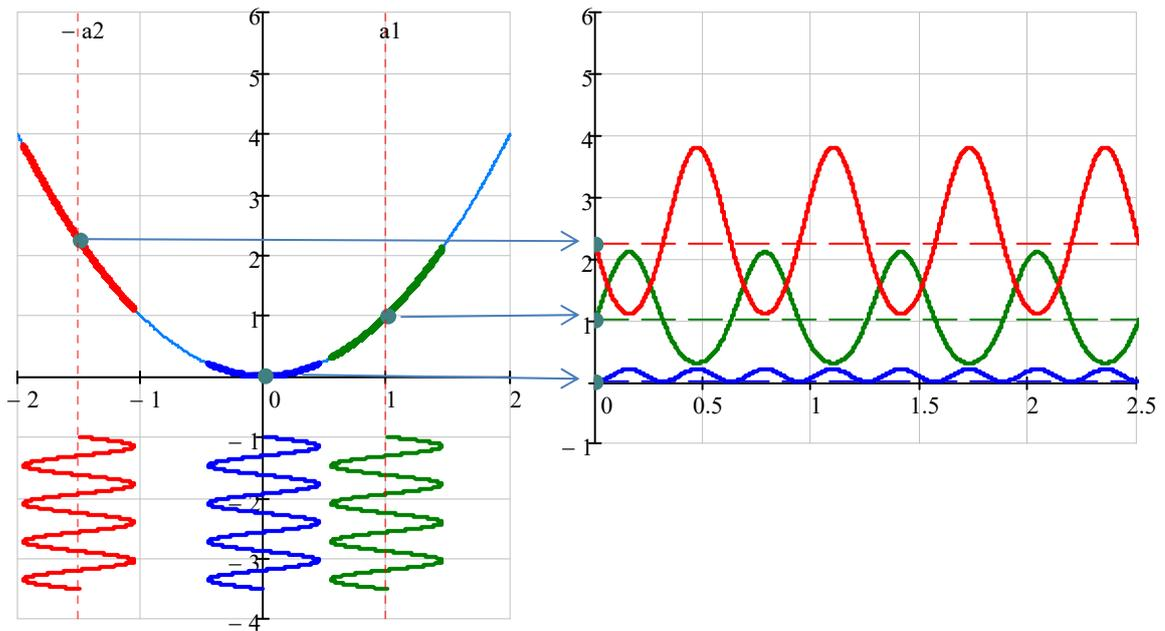
По фазе сигнала определяют, с какой стороны от минимума функционала находится система.
