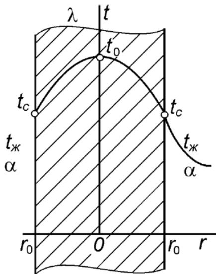
Рассмотрим круглый цилиндр, радиус которого мал по сравнению с длиной. При этих условиях температура будет изменяться только вдоль радиуса. Рассматриваемая задача соответствует случаю цилиндрического тепловыделяющего элемента без оболочки (длинный топливный стержень или столб цилиндрических топливных таблеток).
