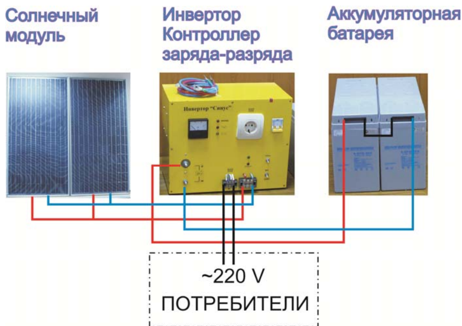
Рис. 4. Система автономного электроснабжения
