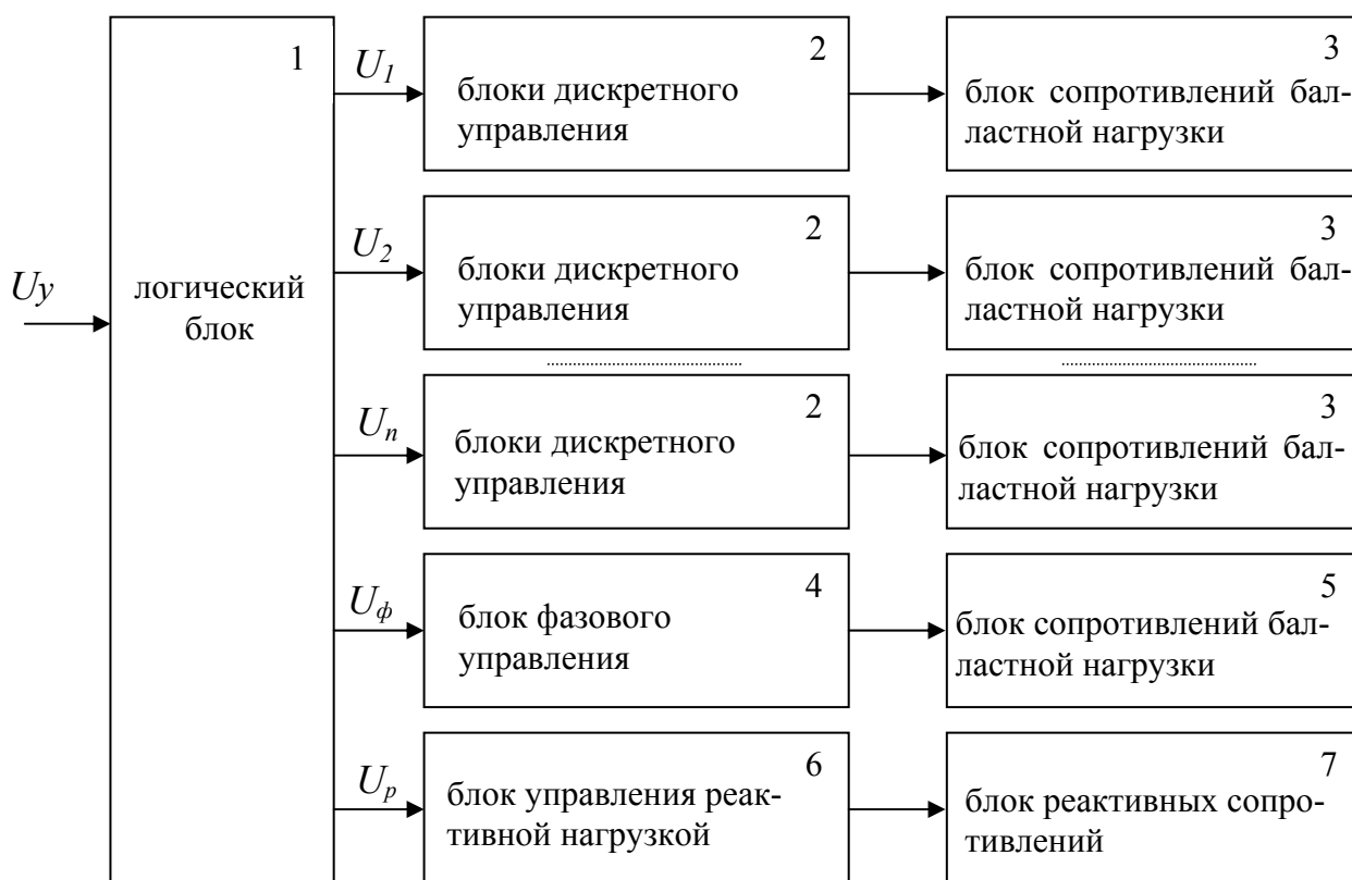
Рис.2.20 Устройство для регулирования амплитуды и частоты напряжения автономного электрогенератора
