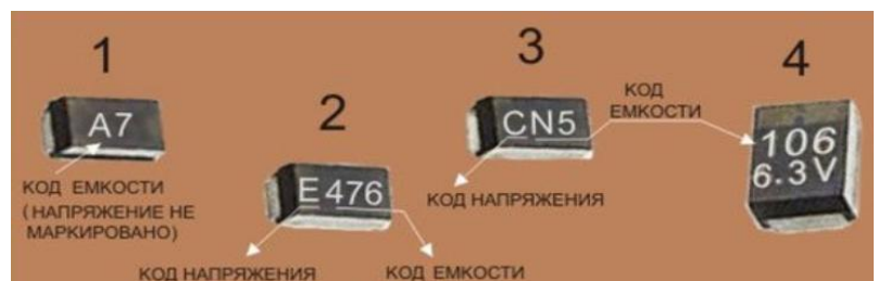
Рис. 1.4. Маркировка SMD конденсаторов
