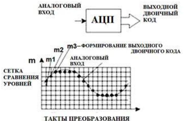
Рис. 5. Преобразование аналогового сигнала в цифровой код
