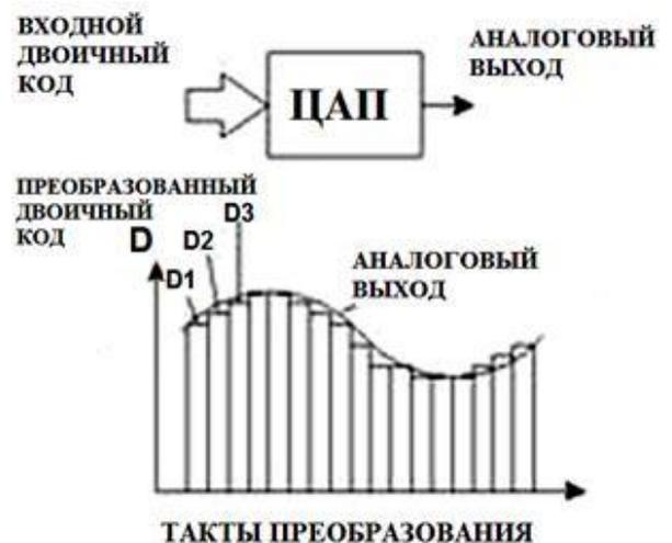
Рис. 1 Преобразование двоичного кода в аналоговый сигнал.
