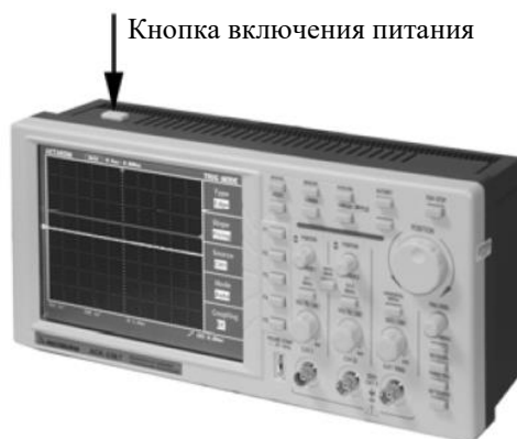
Рис. 2.9. Включение питания осциллографа АСК-2067
