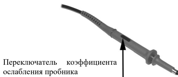
Рис. 2.10. Переключатель коэффициента ослабления пробника
