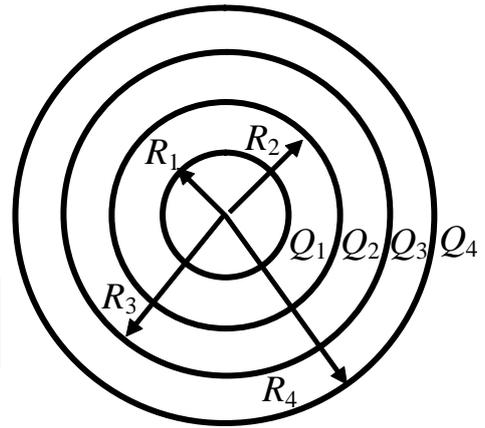
2. На рисунке приведена система заряженных коаксиальных длинных цилиндров. Радиусы цилиндров  $R_1=10$  см,  $R_2=20$  см,  $R_3=30$  см,  $R_4=40$  см.
