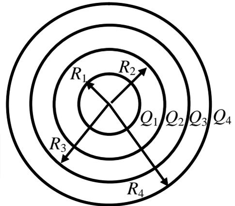
2. На рисунке приведена система заряженных коаксиальных длинных цилиндров. Радиусы цилиндров  $R_1=10$  см,  $R_2=20$  см,  $R_3=30$  см,  $R_4=40$  см. Определить разность потенциалов между внутренним и внешним цилиндрами, если заряд на цилиндрах распределен по длине. Линейные плотности зарядов указаны в таблице.
