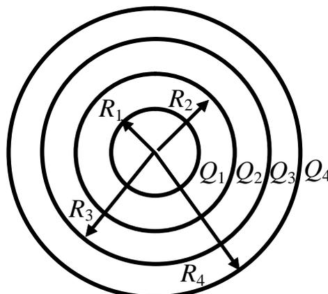
2. На рисунке приведена система заряженных коаксиальных длинных цилиндров. Радиусы цилиндров  $R_1=10$  см,  $R_2=20$  см,  $R_3=30$  см,  $R_4=40$  см.
