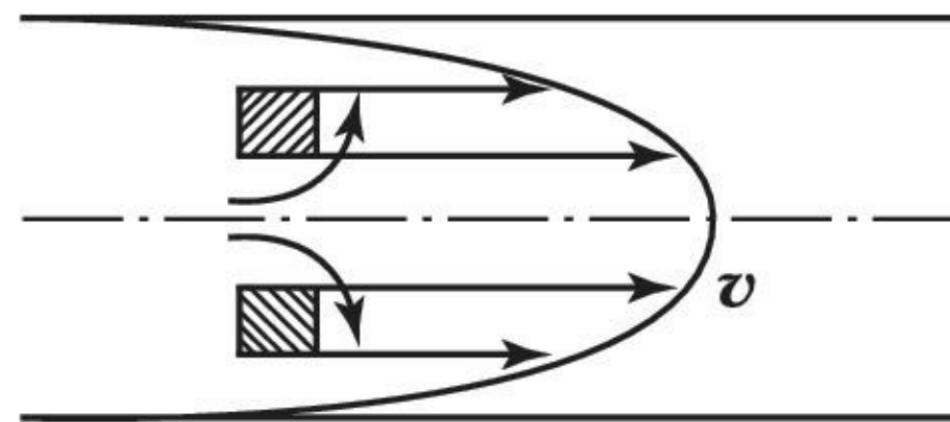
В разных точках живого сечения потока скорость частиц жидкости неодинакова. Около оси трубы скорость максимальна, а по мере приближения к стенкам она уменьшается. Однако во многих случаях закон распределения скоростей в поперечном сечении потока неизвестен или его трудно учесть. Поэтому в расчетах обычно используют не истинные (локальные) скорости, а **фиктивную среднюю скорость**.
