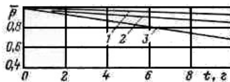
Рис. 1.4. Изменение во времени безразмерного среднеинтегрального пластового давления при упругом режиме
