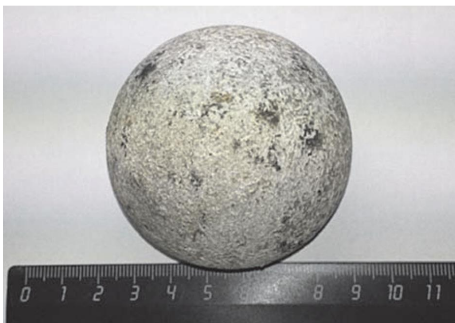
Рисунок 20 – Шар-отсекатель для активации циркуляционного клапана
