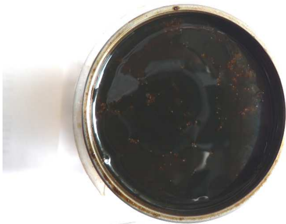
Рис. 6 «а». Осадок АСПО после взаимодействия 15 %-ной ингибированной HCl (без ПАВ) с нефтью
