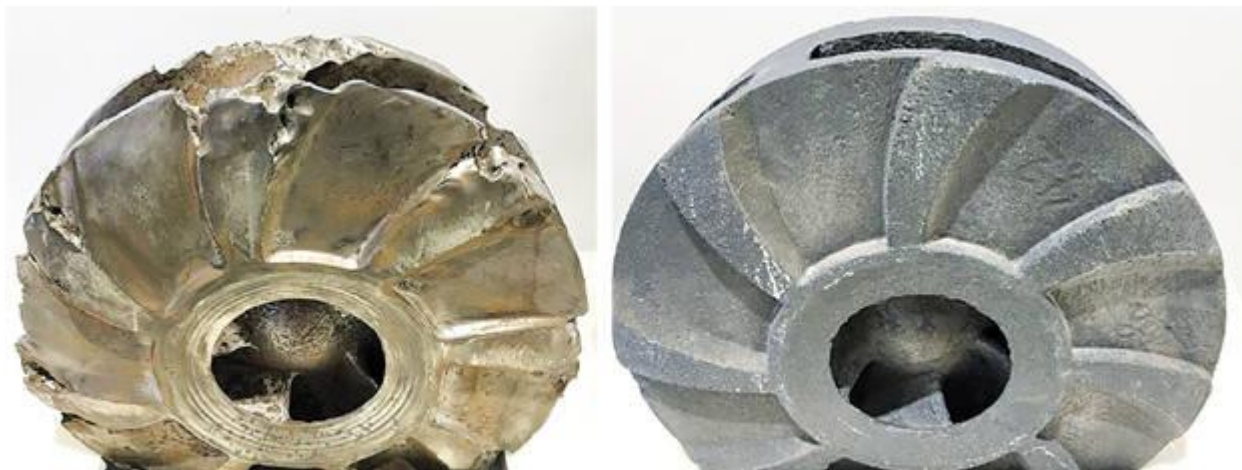
Рис. 1. Сравнительный вид рабочего колеса шламового насоса, изготовленного из стали и рабочего колеса, изготовленного из карбида кремния.
