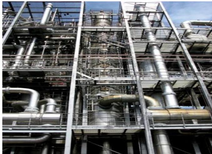
**Риформинг** проводят в промышленной установке (*платформинг*), при  $t=480-520$  °С, в присутствии различных катализаторов: платиновых и полиметаллических, содержащих платину, рений, иридий, германий и др. Во избежание дезактивации катализатора риформинг осуществляется под высоким давлением (18-24 атм). В результате риформинга бензиновых фракций нефти получают 80-85% бензин с октановым числом 90-95, 1-2% водорода и остальное количество газообразных углеводородов.
