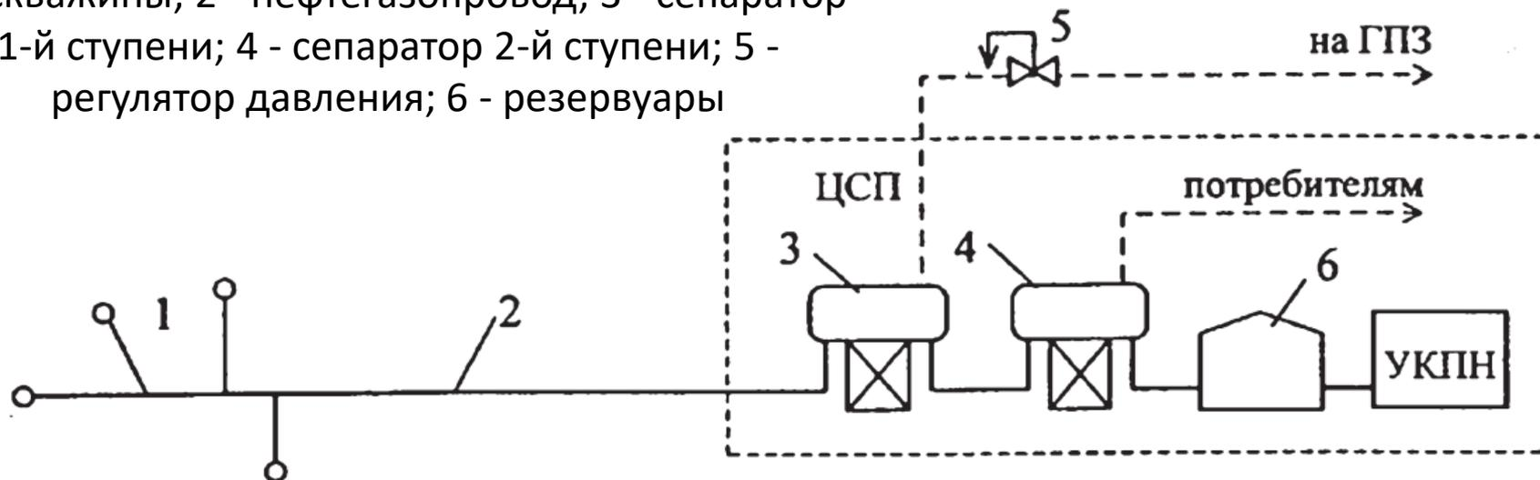
Благодаря этому достигается максимальная концентрация технологического оборудования, укрупнение и централизация сборных пунктов, сокращается металлоемкость нефтегазосборной сети, исключается необходимость строительства нефтеперкачивающих и компрессорных станций на территории промысла, обеспечивается возможность утилизации попутного нефтяного газа с самого начала разработки месторождений.
