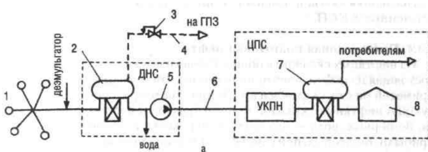
1 - скважины; 2 - сепаратор 1-й ступени; 3 - регулятор давления типа «до себя»; 4 - газопровод; 5 - насосы; 6 - нефтепровод; 7 - сепаратор 2-й ступени; 8 - резервуар; ДНС - дожимная нефтеперекачивающая станция
