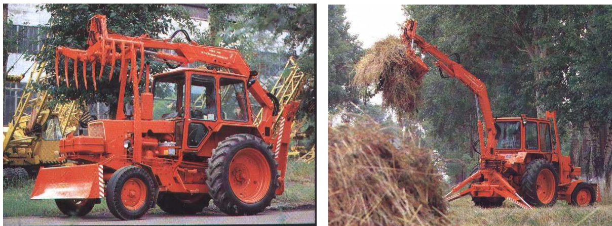
Рис. 8.1. Погрузчик-экскаватор ПЭ-Ф-1А (фото – URL: http://autocranes.narod.ru/pogexk.html )
