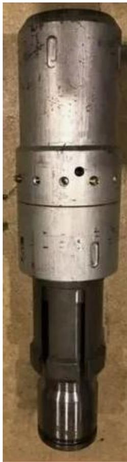
***Клапан-отсекатель*** - клапан, предназначенный для автоматического отсечения потока флюида, исходящего из нефтяной или газовой скважины
