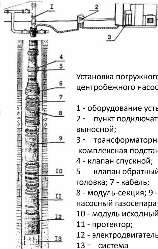
Установка погружного центробежного насоса:
