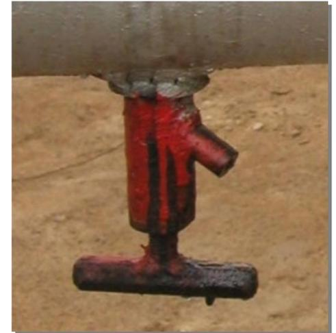
**Пробоотборник** предназначен для отбора проб жидкости, поступающей из скважины.
