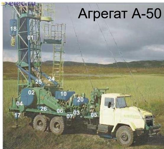
1. Подъемники для спуско-подъемных операций внутрискважинной части фонтанных и газлифтных лифтов, скважинных насосов всех типов, колонн труб, штанг, кабеля. В состав подъемников входят привод, лебедка, транспортная база, полиспастная система, которые используются в основном для текущего ремонта.
