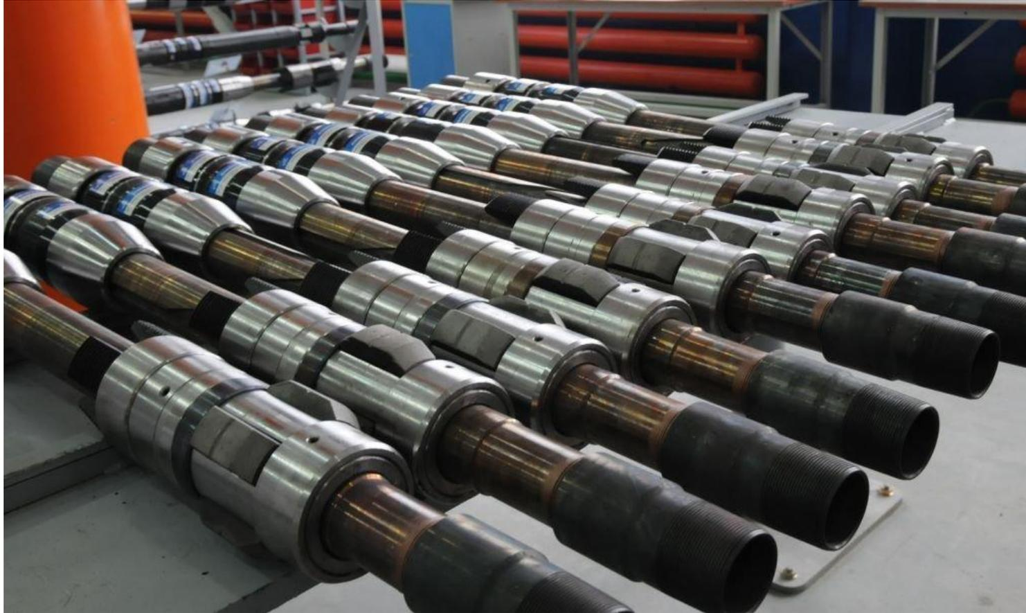
*Пакер* (англ. packer –уплотнитель) - уплотняющее приспособление в буровой скважине, предназначенное для разобщения друг от друга различных частей кольцевого пространства ствола скважины
