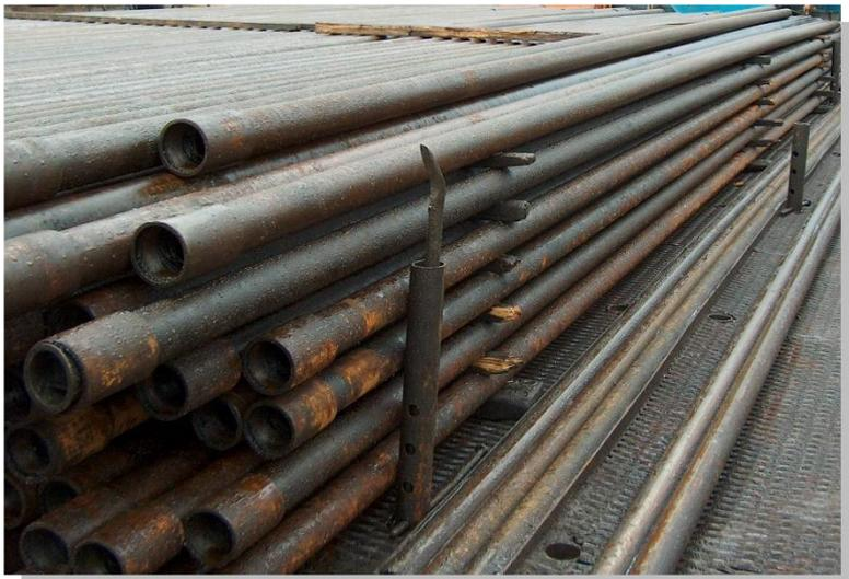
ГОСТ 633-80 регламентирует выпуск бесшовных (цельнотянутых) НКТ следующих условных (наружных) диаметров, мм: гладкие – 48, 60, 73, 83, 102, 114 и с высаженными наружу концами – 33, 42, 48, 60, 73, 89, 102, 114. Толщина стенок от 4 до 7 мм, длина трубы от 5,5 до 10 м (в среднем 8 м). НКТ выпускаются из стали группы прочности Д, К, Е, Л, М. Конструкция резьбового соединения специальная.
