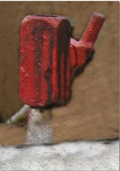
**Вентиль** предназначен для установки манометра (прибора для контроля давления). Монтируется в верхней части обвязки устья скважины.
