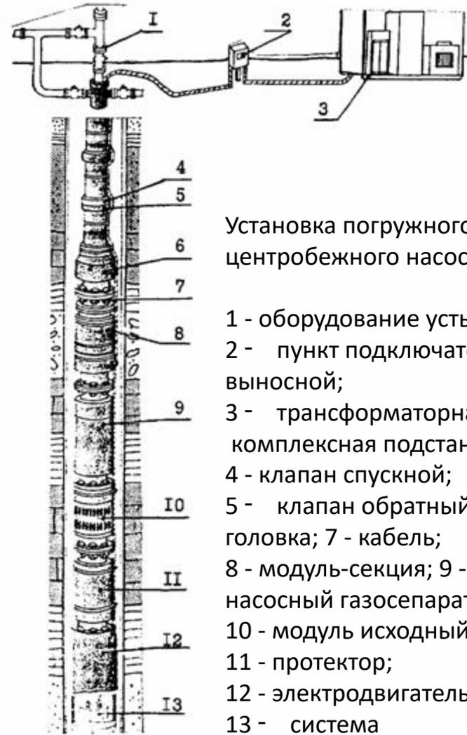
Установка погружного центробежного насоса:
