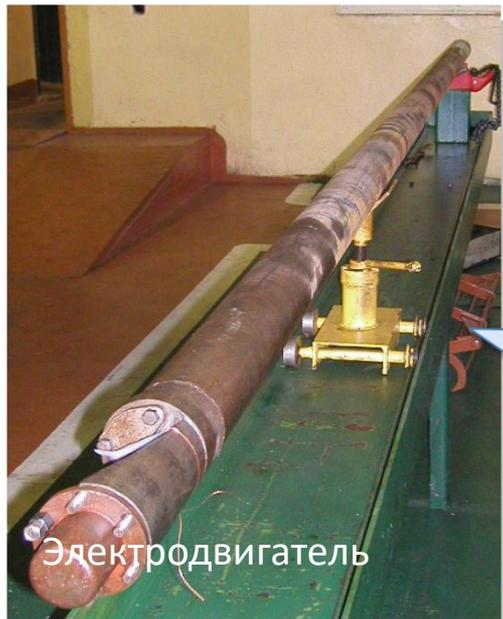
Погружной центробежный модульный насос ("насос") – многоступенчатый вертикального исполнения.
