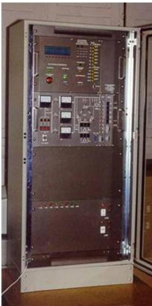
*Рис. 3.2. Шкаф микропроцессорной системы управления, релейной защиты и автоматики (СУРЗА) СТК*
