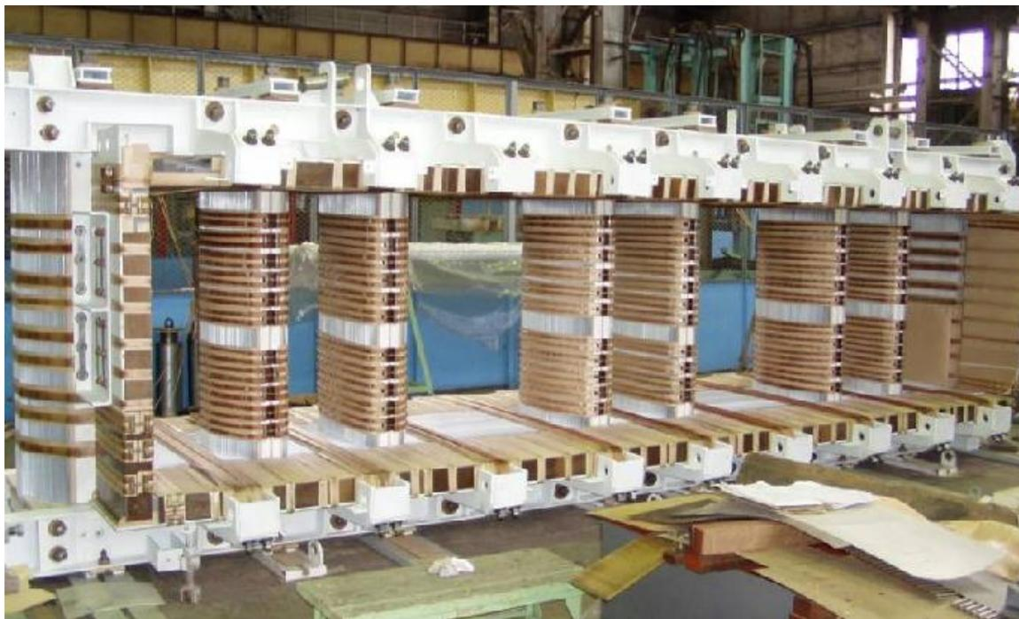
*Рис. 3.18. Магнитная система трехфазного УШР с подмагничиванием*
