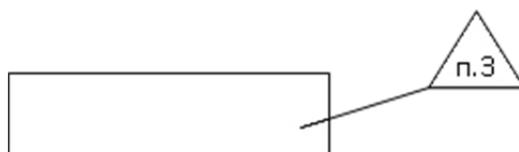
Рис. 2.5. Пример указания о клеймении на чертежах
