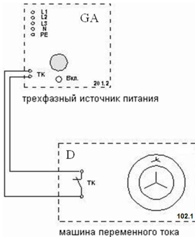
Рис. 1.2. Схема тепловой защиты машины переменного тока
