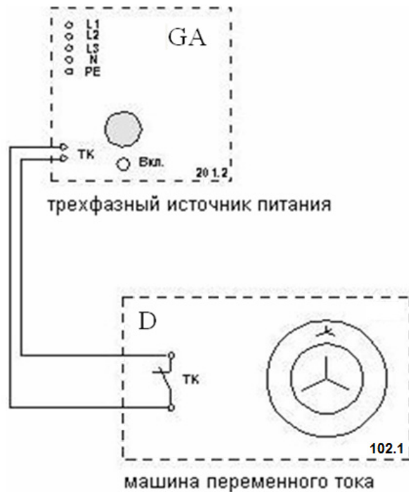
Рис. 3.3. Схема тепловой защиты машины переменного тока
