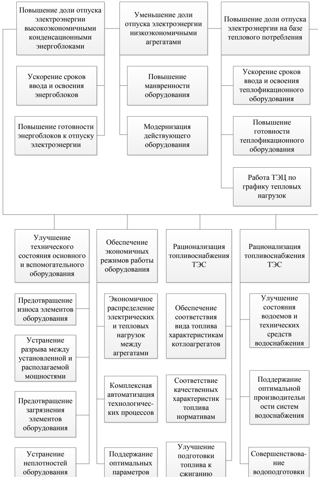
Рис. 1.1. Основные направления рационализации топливоиспользования в генерирующих компаниях и на электростанциях
