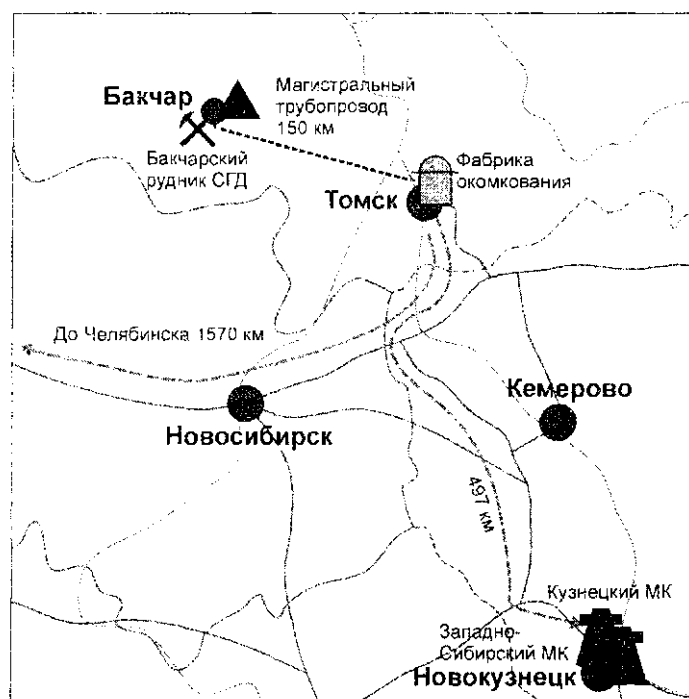
Рис. 5. Схема транспортировки бакчарской железной руды
