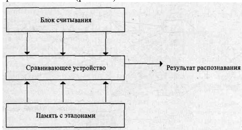
Рис. 7.4. Схема считывателя с распознаванием методом эталонов
