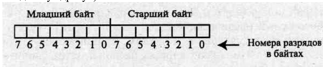
Рис. 5.4. «Вращение» байтов при чтении машинного слова из ОП
