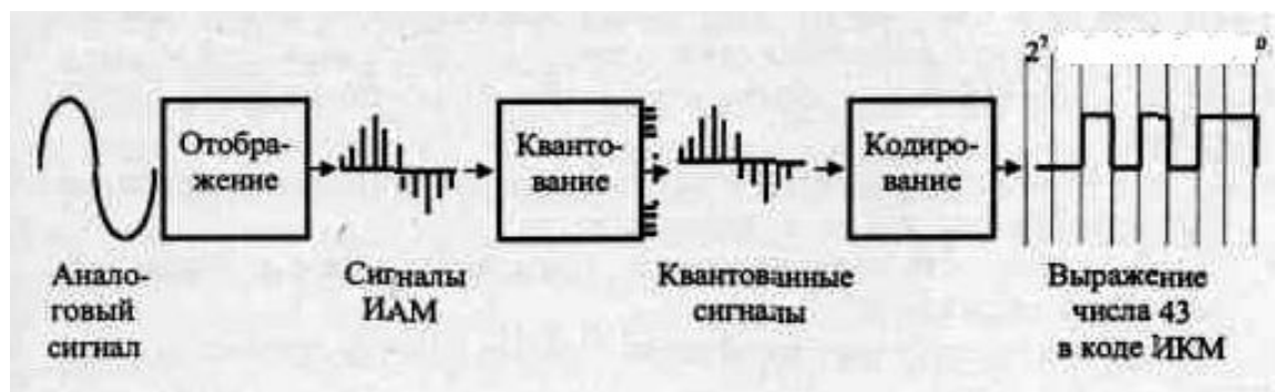
Рис. 13.3. Преобразование аналогового сигнала в 8-элементный цифровой код Первый этап основан на теории отображения Найквиста. Основное положение этой теории гласит: «если аналоговый сигнал отображается на
