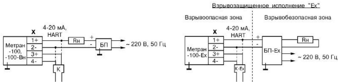
Рис. 3.24. Схемы подключения HART-датчика к каналу измерения и источнику питания
