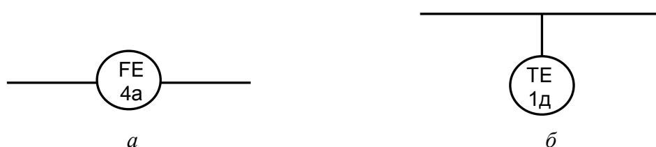
Рис. 2.12. Примеры подключения КИПиА к технологической обвязке: а – чувствительное устройство измерения расхода; б – чувствительное устройство измерения температуры
