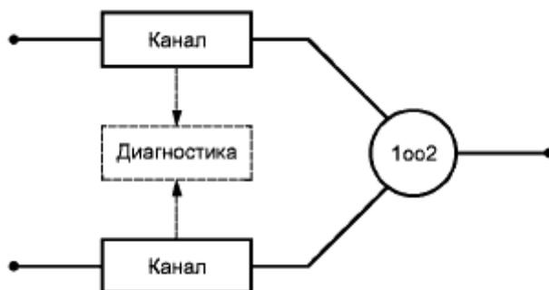
Рис. 5.8. Структурная схема технического обслуживания архитектуры 1oo2
