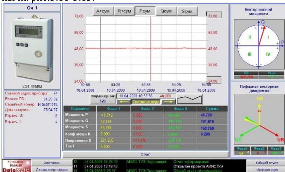
Рис. 3.11. Экран контроля потребления электрической энергии
