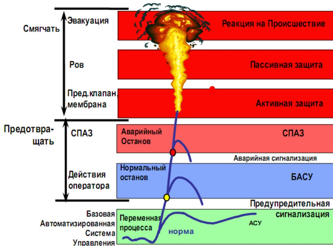
Рис. 5.3 Слои защиты технологического процесса НГО
