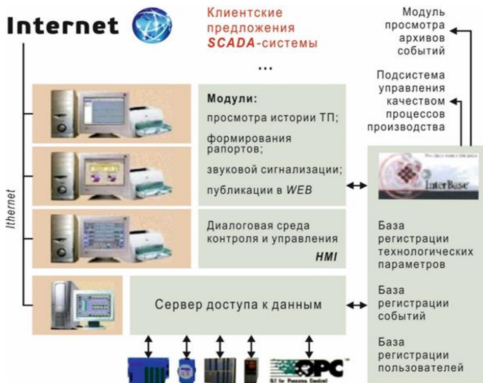
Рис. 10.3. Основные модули SCADA-системы
