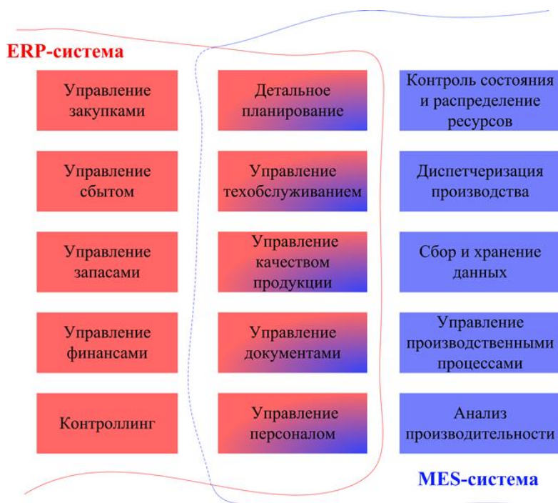
Рис. 3.10. Функциональные возможности ERP и MES-систем
