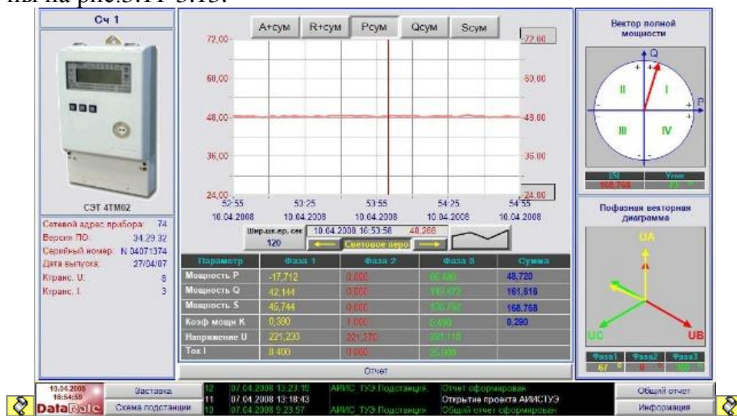
Рис. 3.11. Экран контроля потребления электрической энергии
