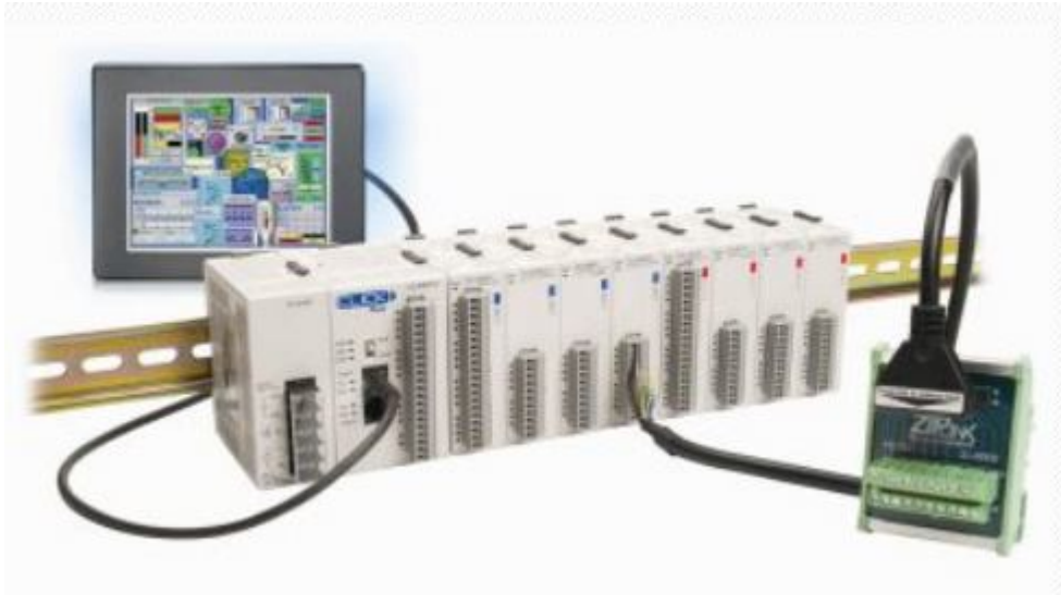
Рис.11 Организация расширенного ввода/вывода ПЛК на DIN рейке.
