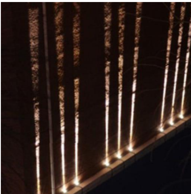
Свет прожекторов с узким лучом 3°
