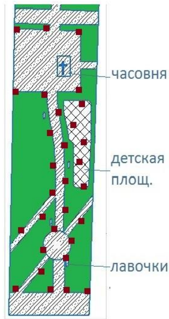
План расстановки светильников
