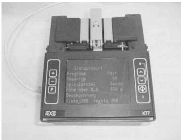
**Рис. 4.27.** Устройство полностью автоматизированного сращивания волокон.
