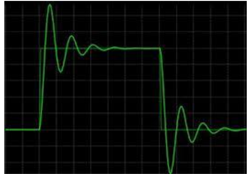
Примеры осциллограмм прямоугольного и почти прямоугольного сигналов
