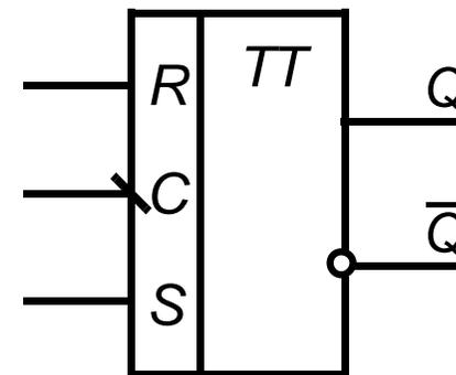
Т.о. работа триггера осуществляется в 2 такта: в первом такте – установка 1 триггера ( $M$ -ячейки); во втором такте информация из  $M$ -ячейки переписывается в  $S$ -ячейку.
