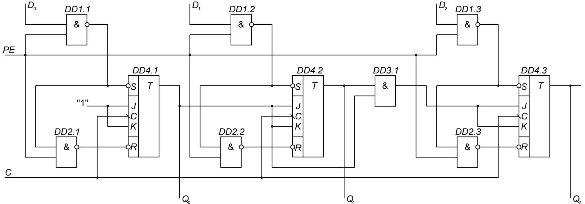
Схема трёхразрядного счётчика с предварительной установкой
