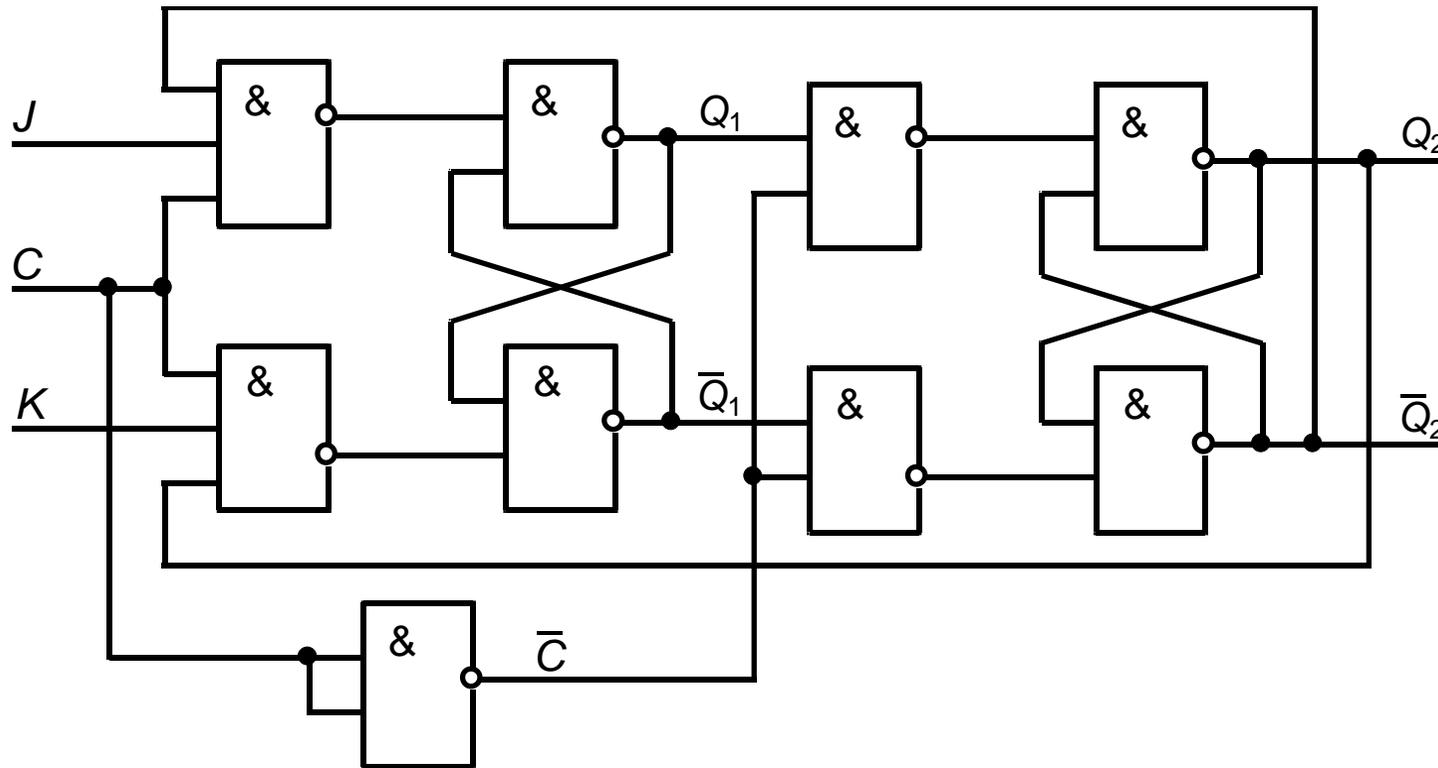
В данном случае JK-триггер выполнен по MS-схеме. Дополнительно могут присутствовать входы асинхронной установки *R* и *S*.
