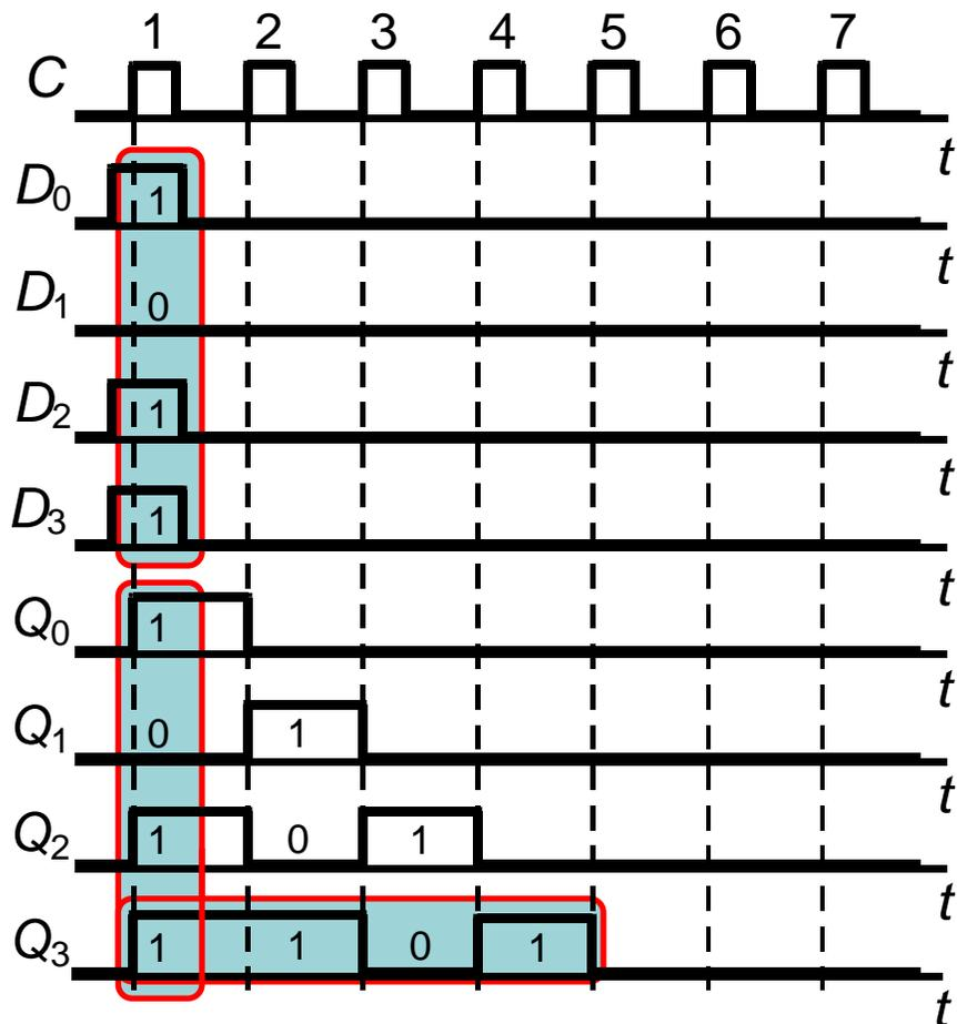
В первом такте информация на  $D$ -входах записывается в триггеры и с каждым последующим тактовым импульсом сдвигается влево (в сторону старших разрядов). На выходе  $Q_3$  через 4 такта получаем информацию в последовательном коде.
