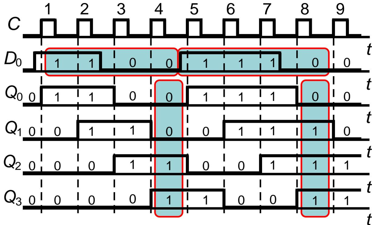
Вход  $D_0$  используется в качестве информационного. На вход  $D_0$  поступает информация в последовательном коде, т.е. данные вводятся в регистр последовательно (поразрядно).  $D$ -триггер – триггер с задержкой (передает информационный сигнал с  $D$ -входа на выход  $Q$  с задержкой в один такт).
