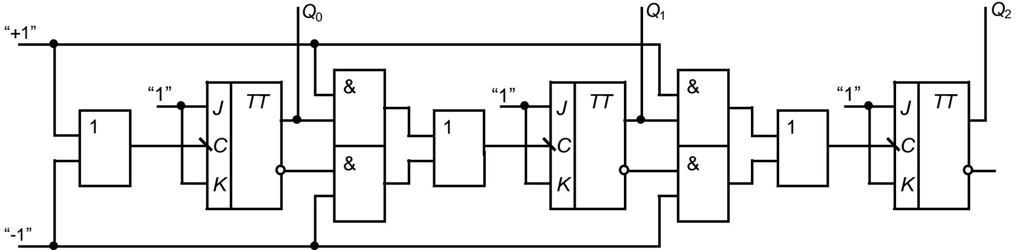
В режиме вычитания входные импульсы подаются на вход «-1», при этом на вход «+1» подаётся лог. 0.
