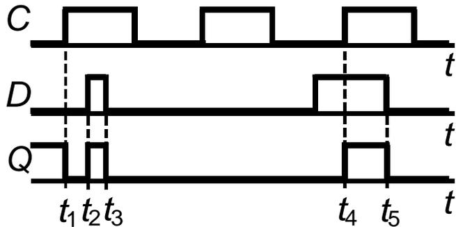
при  $C = 1$  изменение сигнала на входе  $D$  вызывает изменение сигнала на выходе  $Q$ .
