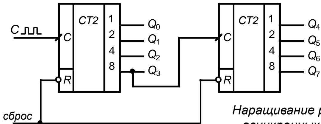
Наращивание разрядности асинхронных счётчиков
