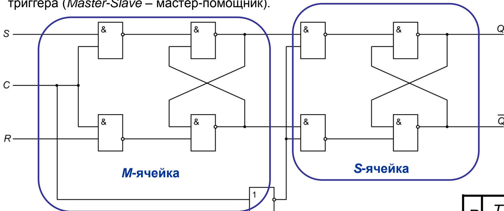
**при  $C = 1$**  ячейка  $M$  прозрачна по вх.  $S, R$ ;
