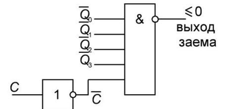
Синхронный счётчик, т.к. выходные сигналы появляются по каждому тактовому импульсу. Счётчик с параллельным переносом (или параллельного типа), т.е. значение  $Q_i$  меняется, когда младшие разряды заполнены единицами.
