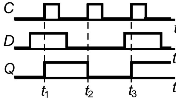
Триггер задерживает (хранит) информацию до следующего синхроимпульса.
